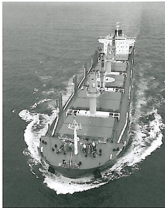
„United Tangaroa“ verfügt über vier 30,5-Tonnen-Krane
