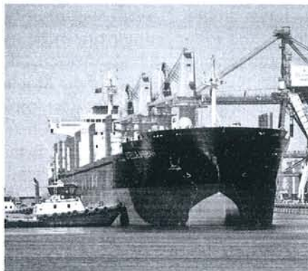
Doppelhüllen-Handysize-Bulkcarrier mit bordeigenem Ladegerüst
